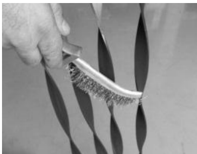
Figura 24 – Limpeza dos canais de passagem de ar e turbuladores
