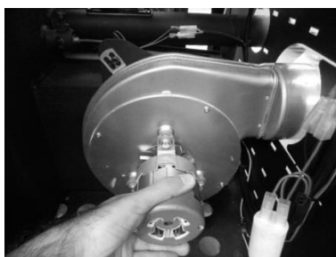
Figura 25 – a) Retirar los tornillos; b) Retirar el extractor
