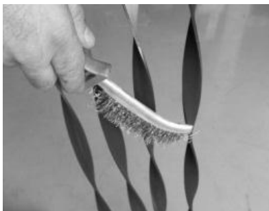
Figura 24 – Limpieza de los canales de paso de aire y turbuladores
