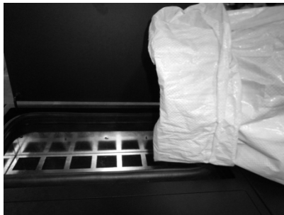
Figura 14 – Reabastecimiento del depósito de pellets
