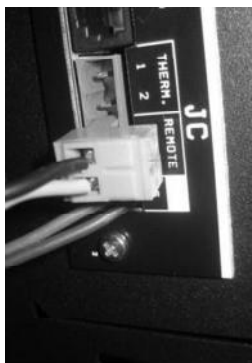
Figura 18 - Instalación del cronotermostato
