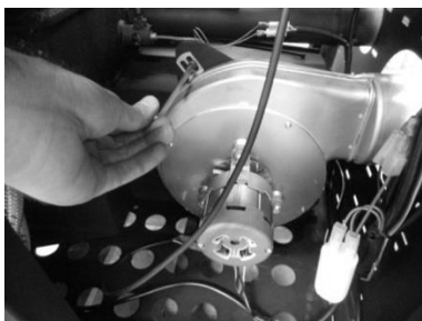
Figura 25 – a) Retirar los tornillos; b) Retirar el extractor
