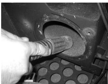
Figura 56 – Aspirar la zona de paso del aire
