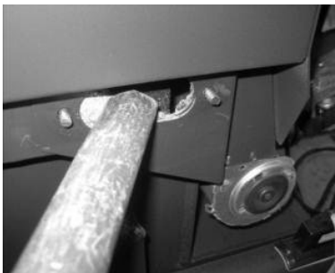
Figura 51 – a) Aspirar el interior ; b) Limpieza con escobillón
