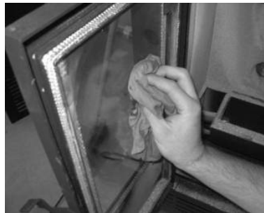
Figura 58 – Limpieza del vidrio: a) aplicar líquido en el paño; b) limpiar el vidrio con el paño
