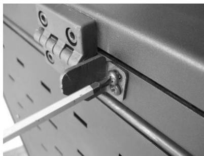
Figura 12 – Montaje del tope de la puerta
