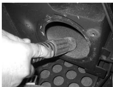
Figura 56 – Aspirar la zona de paso del aire
