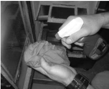
Figura 58 – Limpieza del vidrio: a) aplicar líquido en el paño; b) limpiar el vidrio con el paño
