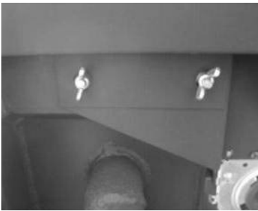
Figura 50 – a) Retirar las tuercas de mariposa; b) Retirar la tapa
