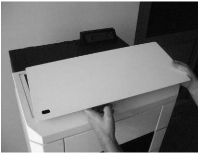
Figura 17 – Colocação da tampa superior
