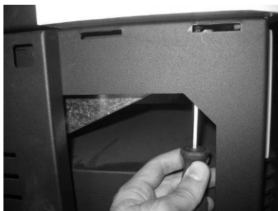
Figura 10 – Montagem da peça superior
