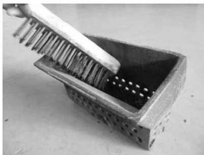
Figura 45 – Limpieza del quemador
