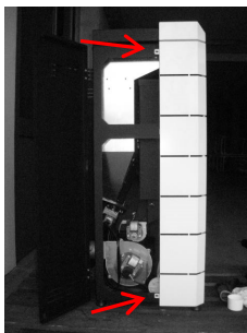
Figura 11 – Montagem das peças laterais
