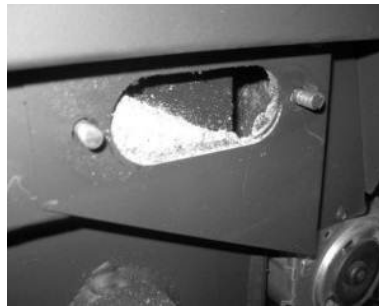
Figura 50 – a) Retirar las tuercas de mariposa; b) Retirar la tapa
