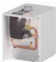
Kit garrafa de equilíbrio Profundidade do kit 250 mm. Ida/retorno 1". Ligação gás 3/4".
