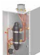
Kit garrafa de equilíbrio Profundidade do kit 250 mm. Ida/retorno 1 1/2". Ligação gás 1".
