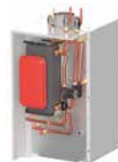
Kit permutador de placas Profundidade do kit 300 mm. Ida/retorno 1 1/2". Ligação gás 1".
